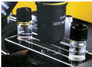
Livrée avec une pipette spéciale pour le remplissage des flacons et l'écoulement des particules en suspension vers la zone d'observation, avec un mode d'emploi.
