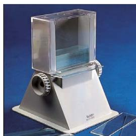
Pratique et très maniable, conserve les lames pour microscopie propres et à l'abri de tout contact avec la poussière. La sortie une à une des lames est obtenue par la rotation d'une molette latérale.
