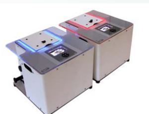
Il est très facile d'utilisation et autonome vis-à-vis de l'ordinateur grâce à son écran simplifié OLED 64x32 pixels (14x8 mm), pour choisir le programme, modifier les paramètres, suivre l'évolution de la température et l'avancement des cycles.
