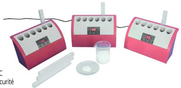
Thermotubes® est particulièrement adapté aux réactions qui requièrent une température précise et constante grâce à son système de régulation..
