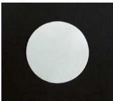
Papier filtre hydrophobe idéal pour séparer rapidement les solvants des phases aqueuses.
